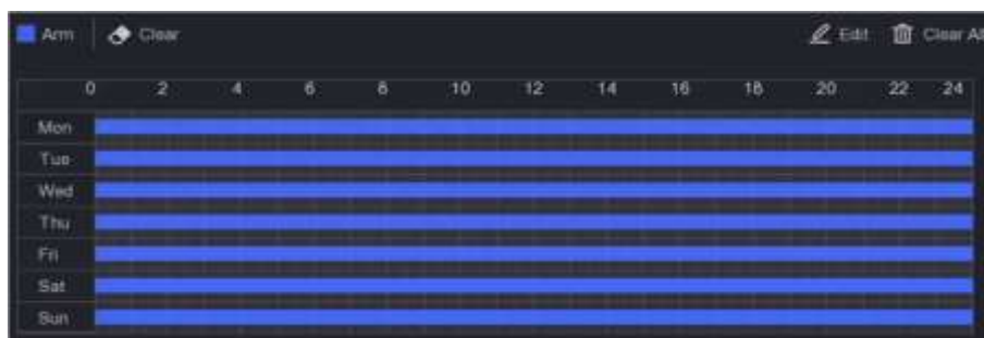
Рисунок 5-14 Настройка расписания постановки на охрану
