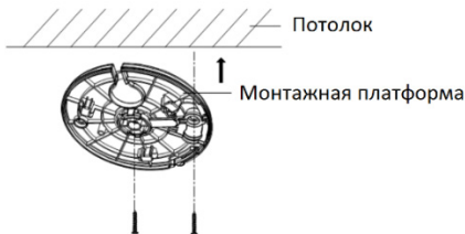
Рисунок 2-3 Установка монтажной платформы
