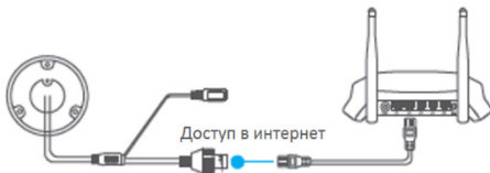
Рисунок 5-3 Подключение к роутеру
