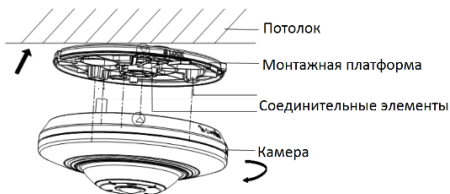
Рисунок 2-4 Установка камеры
