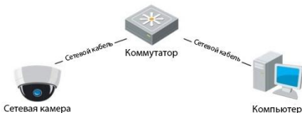
Рисунок 3-2 Соединение через коммутатор или роутер
