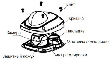
Рисунок 1-23 Настройка угла наблюдения камеры
