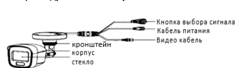
Рисунок 1-5 Цилиндрическая камера IV типа
