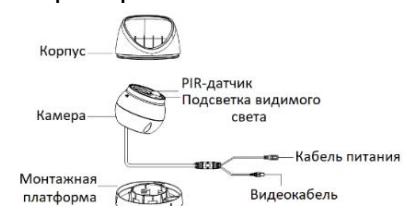
Рисунок 1-18 Камера «шар» III типа
