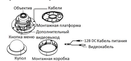
Рисунок 1-14 Купольная камера III типа
