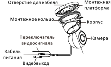
Рисунок 1-20 Камера «шар» V типа
