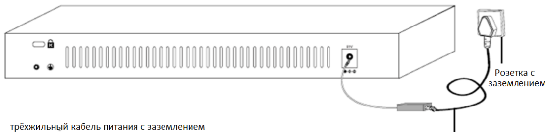
Рисунок 2.9 Заземление с использованием трехжильного кабеля питания
